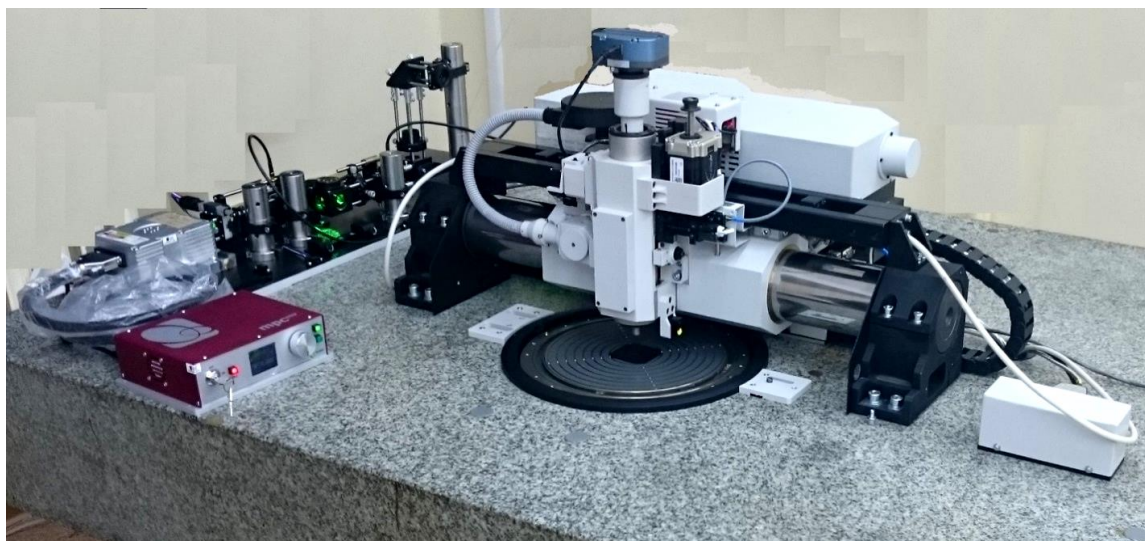
Двухканальная круговая лазерная записывающая система
