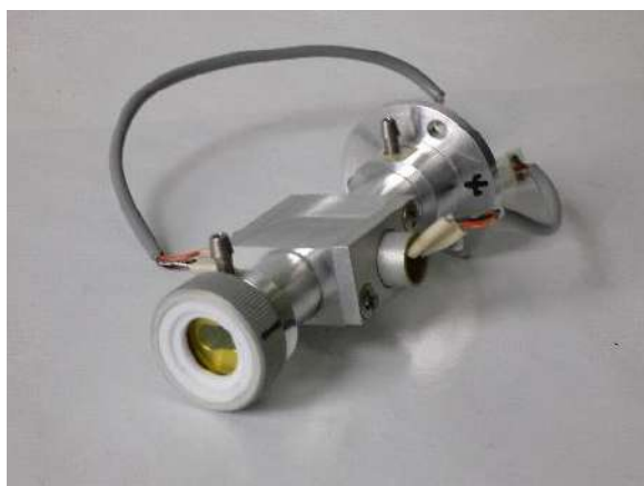
Рисунок А.2.5 – Резонансный кольцевой оптико-акустический детектор (схема Капитанова), использованный в Лазерном ОА-газоанализаторе SF 6 «LLDV-1-2005» (2005)
