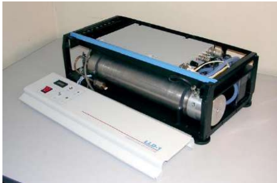
Рисунок А.1.3 – Лазерный ОА-газоанализатор \text{SF}_6 «LLD-1» (2004) со снятыми крышками; виден корпус волноводного \text{CO}_2 лазера, ВЧ-генератор накачки
