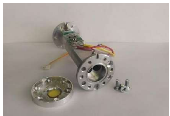
Рисунок А.5.6 – Внешний вид резонансного дифференциального ОАД (модель ОАД-90), использованного в 2007 г. в составе Лазерного ОА-газоанализатора SF 6 «КАРАТ» / «LLDV-1-2007» (модели 2007 г.): акустические резонаторы - Ø8 × 90 мм; буферные полости - Ø20 × 10 мм; микрофоны - EM-6050
