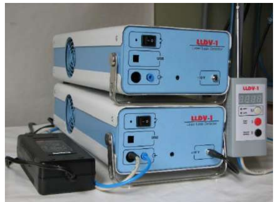
Рисунок А.4.4 – Два опытных экземпляра Лазерного ОА-газоанализатора SF 6 «LLDV-1-2007» (2007 г.) в процессе сборки, перед отгрузкой Заказчику в Республику Корея
