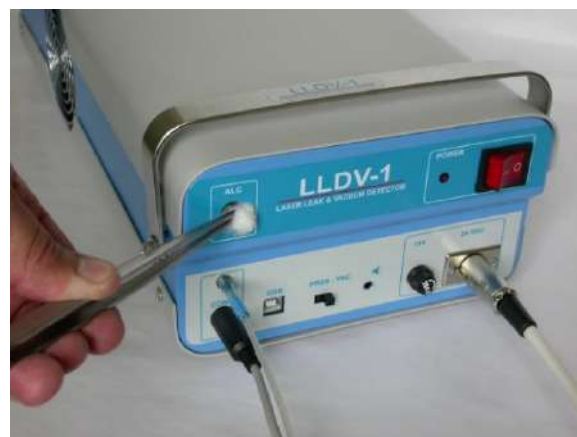
Рисунок А.2.6 – Процедура проверки работоспособности Лазерного ОА-газоанализатора SF 6 «LLDV-1-2005» (2005) по его реакции на пары спирта
