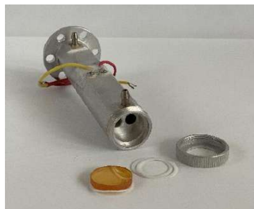
Рисунок А.3.6 – Первый вариант резонансного дифференциального ОАД (модель 2006 г., ИЛФ СО РАН), впервые использованного в составе Лазерного ОА-газоанализатора SF 6 «LLDV-1-2006» / «KARAT-2006»: акустические резонаторы - Ø6 × 90 мм; буферные полости - Ø17 × 8 мм; микрофоны - EM-6050
