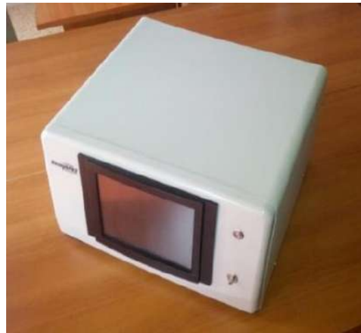
Рисунок Б.1.1 – Структура и внешний вид лазерного ОА-газоанализатора «ЛазерБриз» в сборе (2013 г.)
