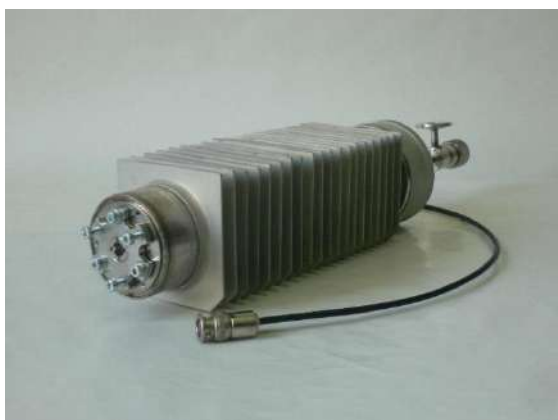
Рисунок А.3.5 – Волноводный CO 2 лазер с ВЧ-возбуждением (разработка А.И. Карапузикова, ИЛФ СО РАН), использованный в составе Лазерного ОА-газоанализатора SF 6 «LLDV-1-2006» / «KARAT-2006» (2006 г.)
