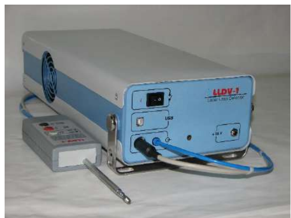
Рисунок А.4.6 – Внешний вид Лазерного ОА-газоанализатора SF 6 «LLDV-1-2007» (2007 г., разработка ИЛФ СО РАН) с ручным пультом управления (отгружен Заказчику в Республику Корея)
