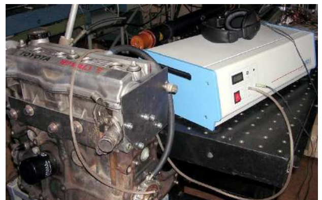
Рисунок А.1.6 – Лазерный ОА-газоанализатор \text{SF}_6 «LLD-1» (2004) в работе; эксперимент по определению мест утечки \text{SF}_6 из автомобильного двигателя (ИЛФ СО РАН)
