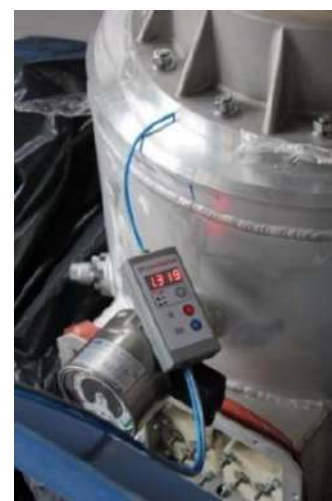
Рисунок А.9.3 – Использование лазерного ОА-течеискателя «KARAT» («SF 6 LaserGasTest») по назначению в производственных условиях (ООО «Эльмаш (УЭТМ)», г. Екатеринбург, 2015 г.)
